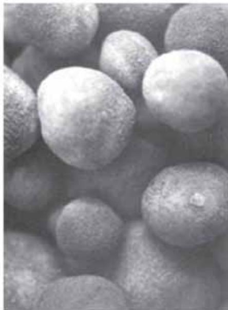
Рис. 5. Гранулированное пеностекло — пеностеклянный гравий (фото с сайта ЗАО "Пеноситал", [www.penosytal.ru](http://www.penosytal.ru))
