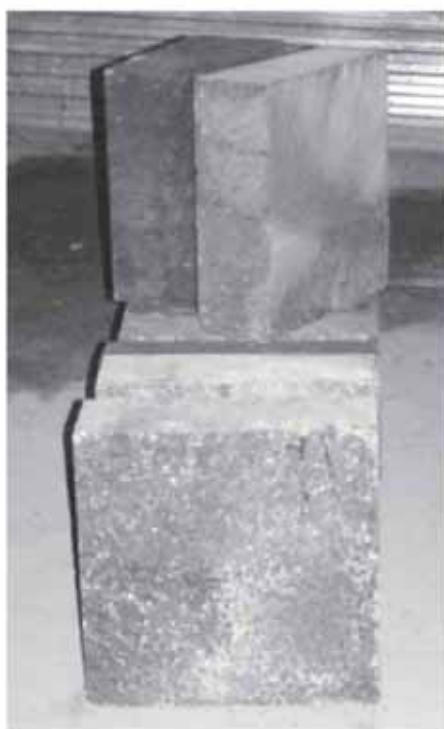
Рис. 4. Блочное пеностекло (фото с сайта ЗАО "Пеноситал", [www.penosytal.ru](http://www.penosytal.ru))
